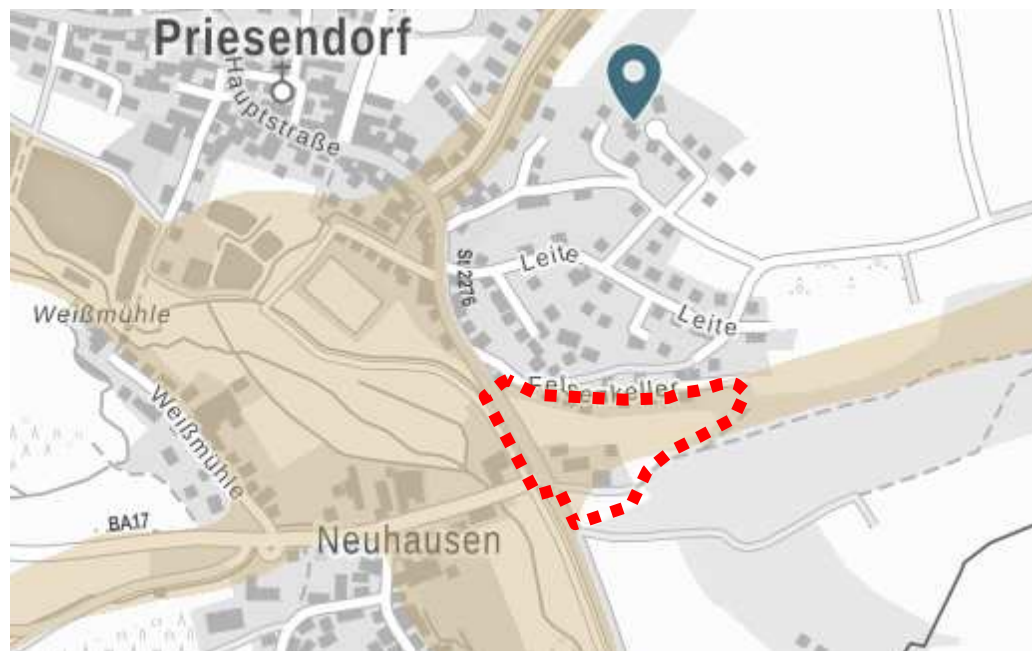
Abb. 10: Wassersensible Bereiche (hellbraune Flächen) im Plangebiet (mit rot gestrichelter Linie schematisch abgegrenzt, Darstellung genordet, o. M., Quelle: „Umwelt Atlas Bayern“)
